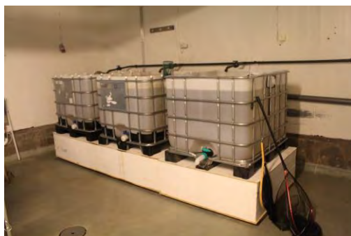
Fig. 1: Kretsloppsbolagets försöksuppsättning med tre fisktankar för Tilapia kopplade till en hydroponisk odling och ett reningssteg med biokol.
