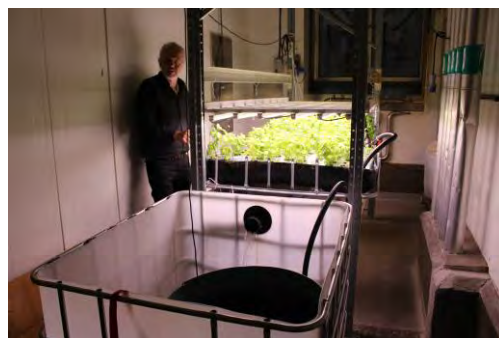
Fig. 1: Kretsloppsbolagets försöksuppsättning med tre fisktankar för Tilapia kopplade till en hydroponisk odling och ett reningssteg med biokol.
