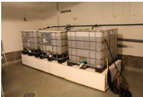
Fig. 1: Kretsloppsbolagets försöksuppställning med tre fisktankar för Tilapia kopplade till en hydroponisk odling och ett reningssteg med biokol.
