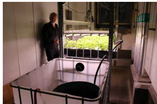
Fig. 1: Kretsloppsbolagets försöksuppställning med tre fisktankar för Tilapia kopplade till en hydroponisk odling och ett reningssteg med biokol.
