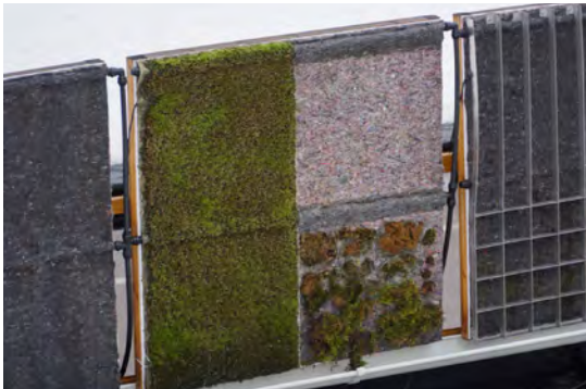
Tester med olika mossor som väggbeklädnad, Greenworks.
